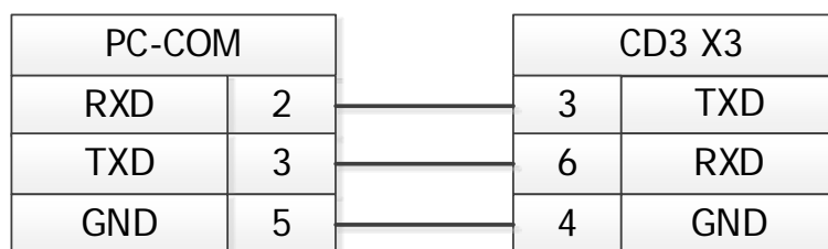
图 9-1 电脑 USB 接口和 CD3 驱动器 RS232 接口连接方式
